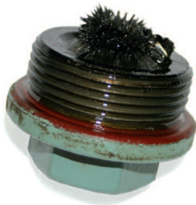
磁気プラグに捕集された摩耗粉
