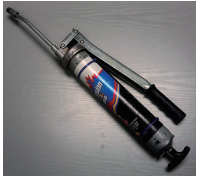
使用済みグリースチューブを巻き付けたグリースガンの一例
