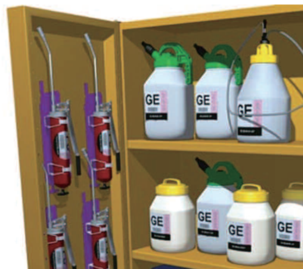
図4 グリースカートリッジの格納にキャビネットを活用
